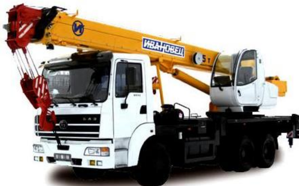
1.12 - сурет - Өздігінен жүретін шассидегі телескопиялық кран – «Ивановец»
