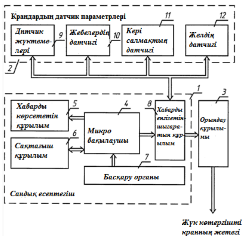
1.1 – сурет - Жібелі кран шектегішінің схемасы
